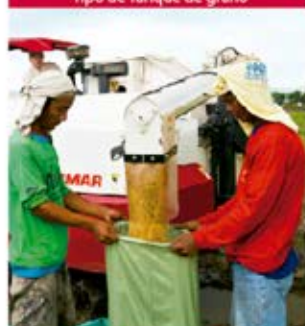
Tubo de descarga de alta velocidad
